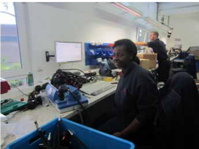
Prüfen der Atemschutzmasken. Genau so wurden gebrauchte Atemschutzgeräte nach dem Einsatz gereinigt und auf einem älteren Prüfgerät, dessen Typ auch in Tansania im Einsatz ist, überprüft. Aber was ist ein Besuch bei der Feuerwehr
