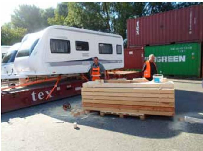
Schwerpunkt unserer Betrachtungsweise war die Ladungssicherung, weil die Sicherung schwere Packstücke gegen Verrutschen mit Balken sehr viele Parallelen zur Aussteifung bei einsturzgefährdeten Gebäuden aufweist. So konnten die beiden Tansanier erleben, wie durch den Einbau passend geschnittener Balken event. auftretende Kräfte bei Container durch die Schiffsbewegungen abgefangen werden.
