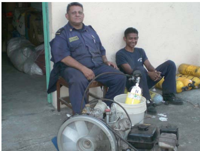
Befüllung von Atemluftflaschen
