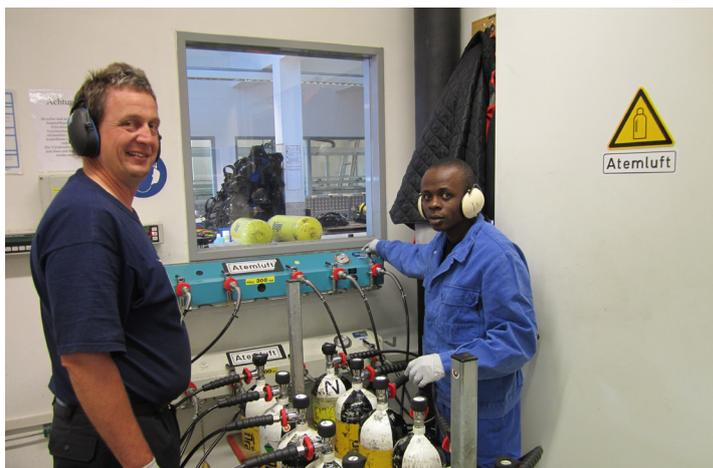
fältigen Zusammenbau erfolgt eine Überprüfung der Funktionen am Prüfgerät, dem Testor. Ist die Kontrolle erfolgreich, wird dieser Lungenautomat im System als geprüft registriert. Bei der Montage der Komplettgeräte treffen wieder Rückenplatte, Atemluftflasche und Lungenautomat zusammen. Die Baugruppen werden per Barcode registriert und als Einsatzgerät gespeichert. Der Zusammenbau erfolgt nach bestimmten Regeln und endet mit einer erneuten Kontrolle. Da-
