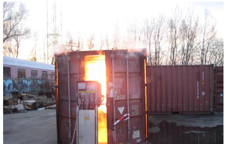
Gasbrenner dargestellt, der vor der geöffneten Containertür aufgebaut ist und durch einen Ausbilder gesteuert, einen Flammenstrahl auf die Zwischentür ausspeit. Durch diese Öffnung müssen die Feuerwehrleute den Zimmerbrand bekämpfen. Der 2. Mann öffnet die Tür, der Angreifer bekämpft die Feuer mit verschiedenen Löschtechniken. Dabei steht er buchstäblich für Sekunden im Feuer, geschützt durch Nomexbekleidung, Flamschutzhaube, Helm, Handschuhe und Atemschutzmaske.
