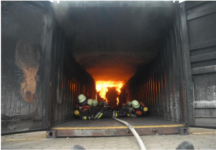
wurde, quillt der heiße unverbrannte Rauch aus dem glutheißen Raum und drängt, von der Decke des Containers herunter bis zur Höhe von ca. 1 m sich ausdehnend, heraus und in Richtung der geöffneten Containertür. Die jungen Feuerwehrkameraden liegen, geschützt durch Atemschutzgerät und ihre Nomex-Bekleidung, auf dem Boden und schauen angespannt nach oben.
