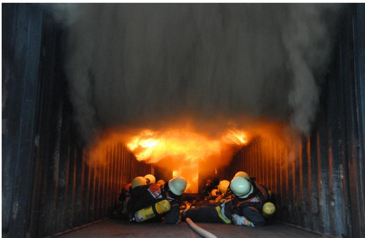
te Flammenfront rollt durch die obere Hälfte des Containers und erreicht in 1 – 2 Sekunden die Tür. Ein typischer Flash Over.
