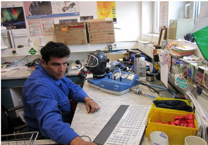
nach ist das Gerät wieder zum Einsatz freigegeben. Bei den Masken erfolgt eine ähnliche Kontrolle. Nach der erneuten Montage der Verbrauchsteile wird die Maske sorgfältig auf Dichtigkeit überprüft. Da genügt ein eingeklemmtes Haar auf dem Prüfkopf, das eine minimale Undichtigkeit erzeugt, um als undicht und damit als nicht einsatzbereit erkannt zu werden. Ist die Maske überprüft und freigegeben, wird diese in eine Plastiktüte eingeschweißt und kann neu ausgegeben werden.
