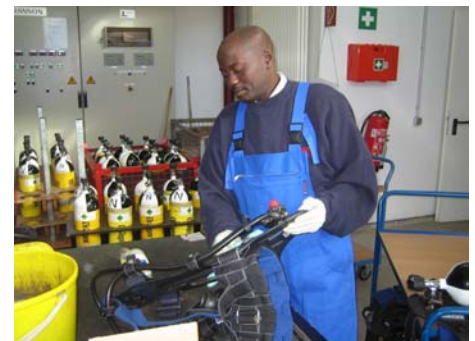
Montage der überholten Baugruppen
