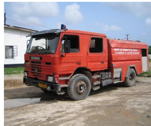
Scania Firetruck mit 5000 l Wassertank
